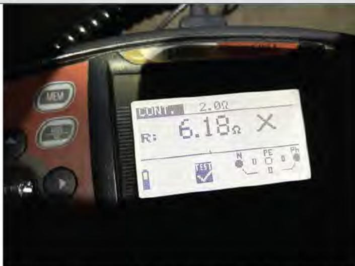
**Description :** La CONNEXION à la LIAISON EQUIPOTENTIELLE principale d'au moins une CANALISATION métallique de gaz, d'eau, de chauffage central de conditionnement d'air, ou d'un élément CONDUCTEUR de la structure porteuse du bâtiment n'est pas assurée (résistance de continuité > 2 ohms).
